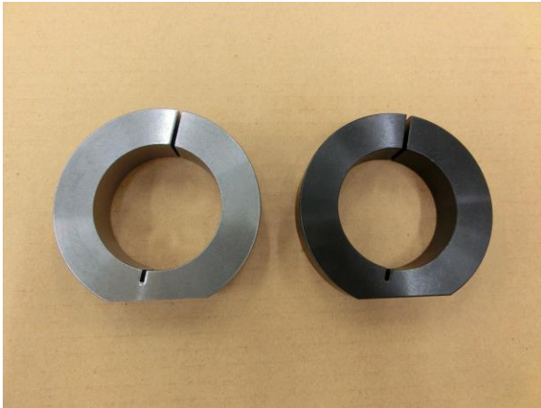
左：新型 右：従来型 写真 セットカラー仕様変更概要（写真は新旧ともに AB142-1 段減速用）
